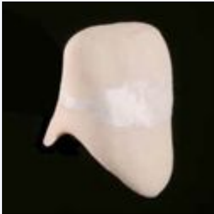
Rys. 4: Napalany opaker w paście z osadzonym białym pierścieniem
