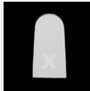
Rys. 5: Nieprawidłowo napalona próbka materiału
