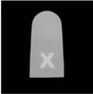
Rys. 5: Prawidłowo napalona próbka materiału
